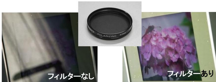
偏光フィルターを使った反射光除去
